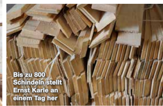
Eng stehende Jahresringe garantieren Beständigkeit des Schindelholzes
